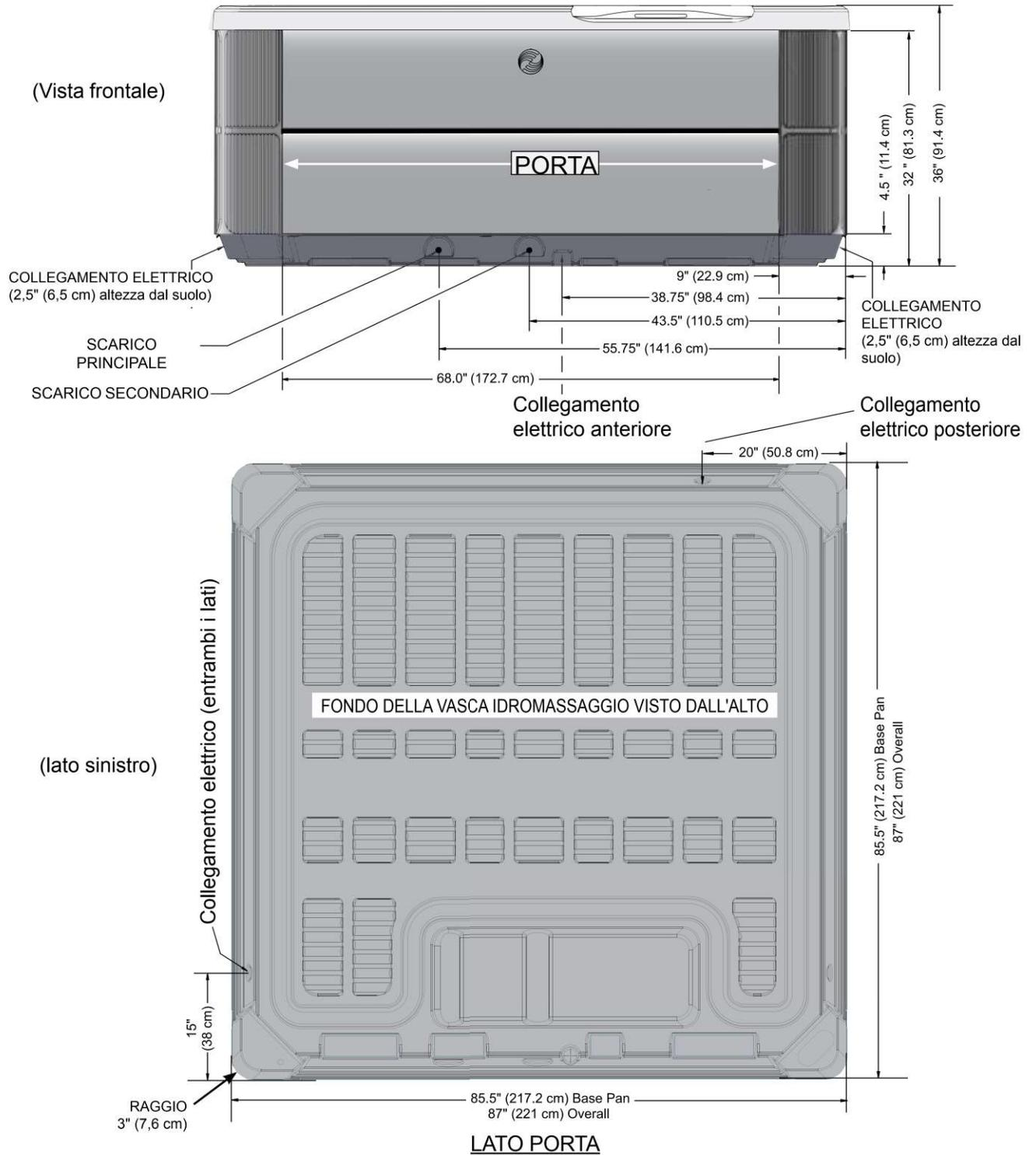
**NOTA:** WATKINS WELLNESS consiglia di installare il modello VANGUARD su una base di cemento armato o su una piattaforma con uno spessore di almeno 10 cm (4") e in grado di sostenere un peso di almeno 630 kg/m<sup>2</sup> (130 libbre per piede quadrato).
