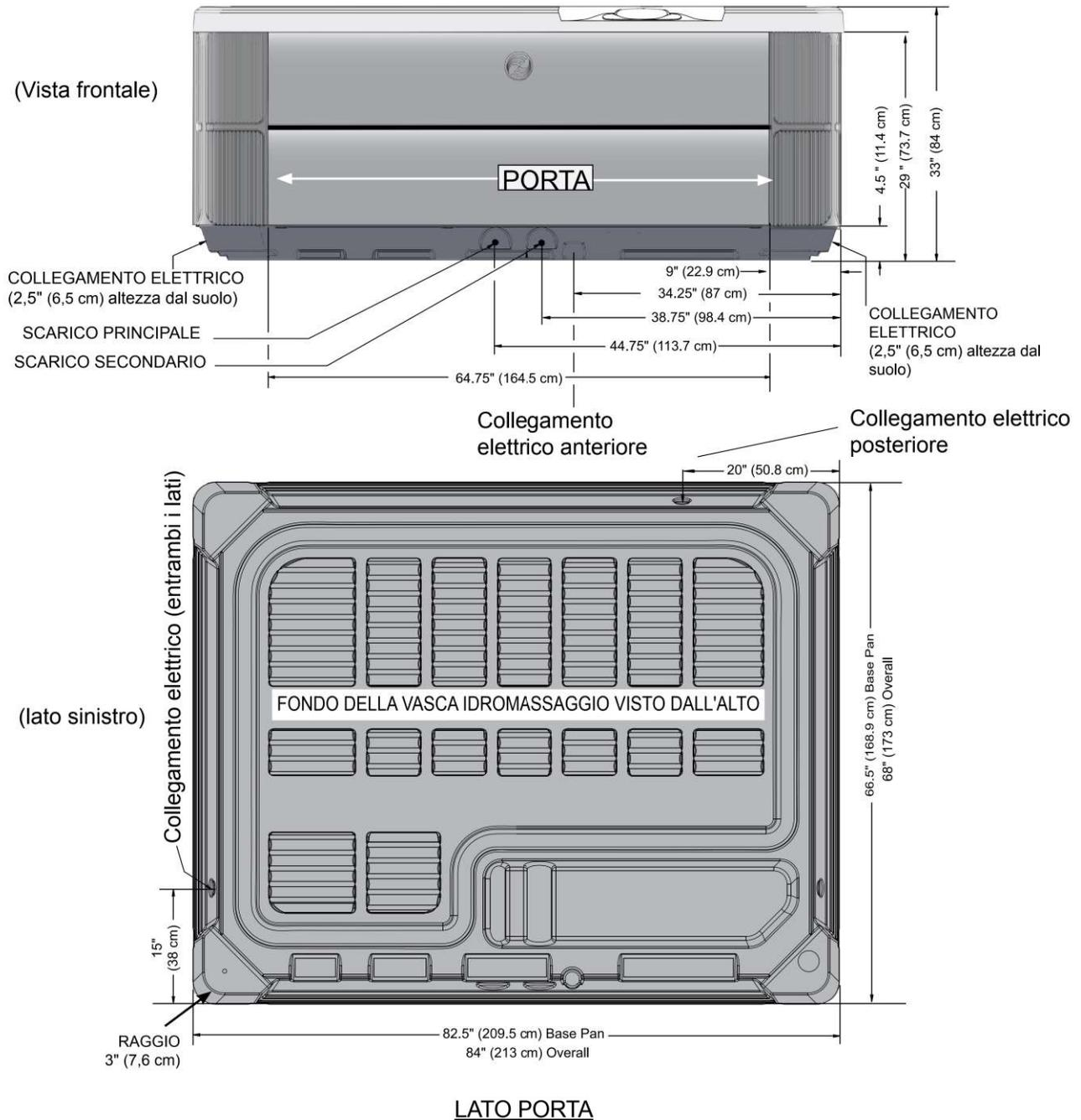
**NOTA:** WATKINS WELLNESS consiglia di installare il modello JETSETTER su una base di cemento armato o su una piattaforma con uno spessore di almeno 10 cm (4") e in grado di sostenere un peso di almeno 555 kg/m<sup>2</sup> (115 libbre per piede quadrato).
