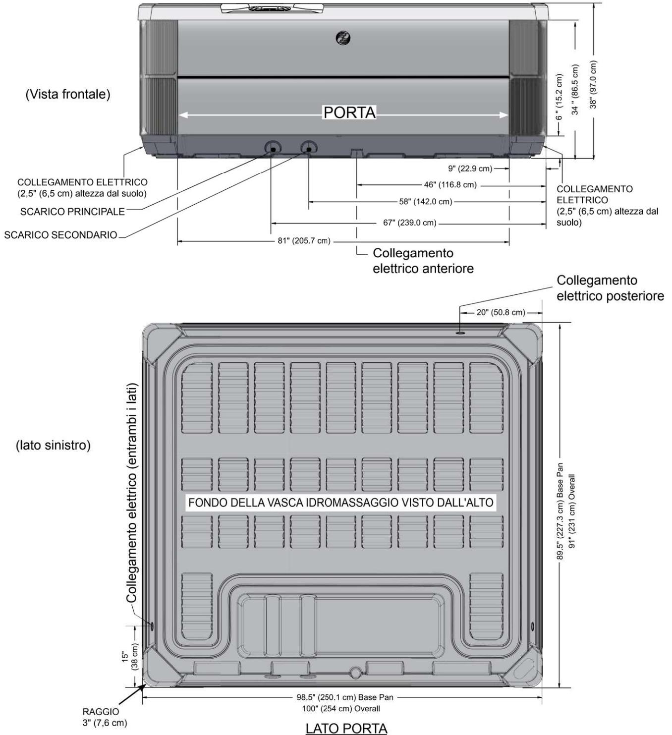
**NOTA:** WATKINS WELLNESS richiede che il modello ENVOY venga installato su una base di cemento armato o su una piattaforma con uno spessore di almeno 10 cm (4") e in grado di sostenere un peso di almeno 570 kg/m<sup>2</sup> (120 libbre per piede quadrato).
