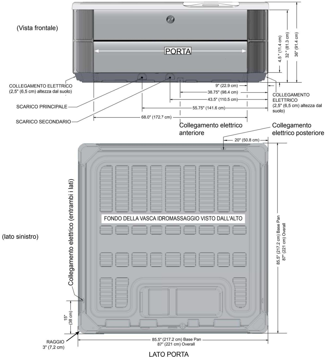
**NOTA: WATKINS WELLNESS** consiglia di installare il modello **ARIA** su una base di cemento armato o su una piattaforma con uno spessore di almeno 10 cm (4") e in grado di sostenere un peso di almeno 595 kg/m<sup>2</sup> (125 libbre per piede quadrato).
